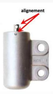
Maintenir le piston en place en insérant la pige de calage adéquate au travers de l'orifice dans le corps du galet tendeur hydraulique.
