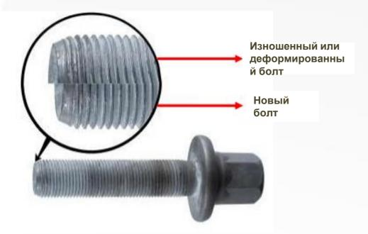
При использовании растянутого болта происходит изменение его механических свойств, и болт уже не соответствует допуску, установленному изготовителем
