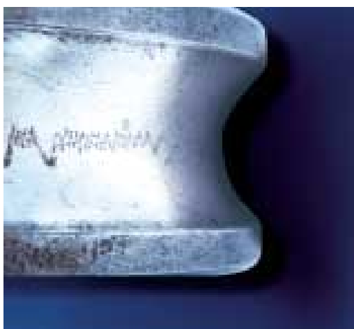
Arco elettrico sull'anello interno
