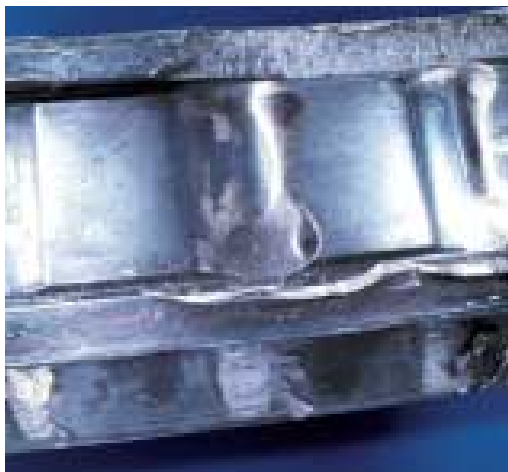
Grippaggio di un cuscinetto oscillante a rulli, incrostazione dei rulli e rottura del colletto
