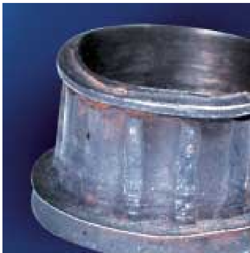
Grippaggio di un cuscinetto con incrostazione dei rulli
