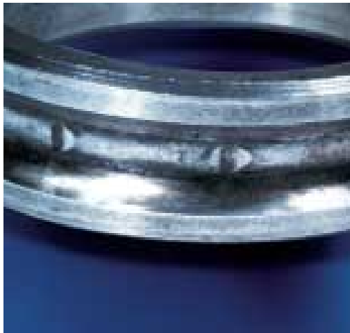
Grippaggio con incrostazione delle sfere
