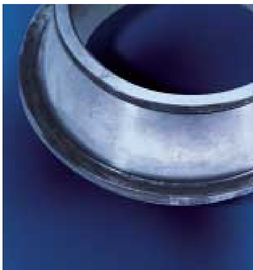
Deterioramento del colletto dovuto ad un eccesso di precarico
