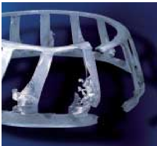
Deterioramento della gabbia dovuto a un inizio di grippaggio
