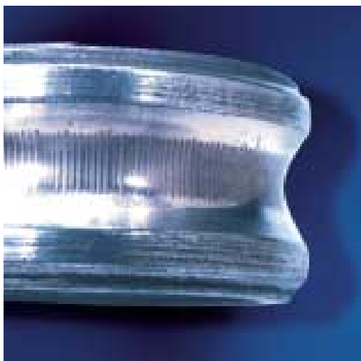
Passaggio di corrente elettrica nell'anello interno in rotazione
