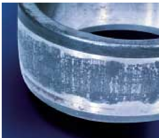
Ossidazione durante il funzionamento (entrata di liquido)
