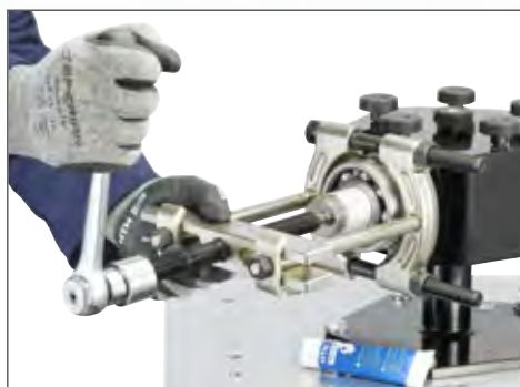
Demontaż za pomocą odklejadza
