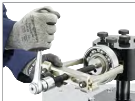
Demontaż za pomocą uchwytu z dwoma ramionami
