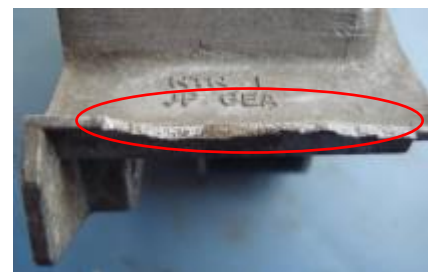
Поврежденный кронштейн крепления натяжителя
