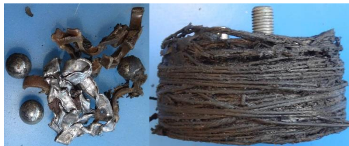
Последствия проскальзывания ремня
