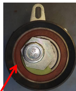
Ролик GT357.28 с обломанным валом
