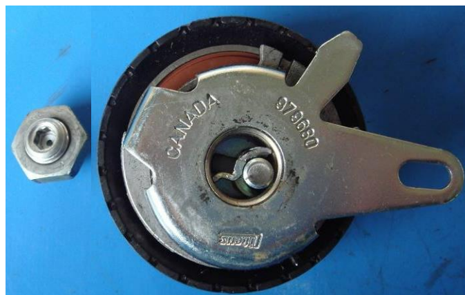
Ролик GT357.28 с обломанным валом
