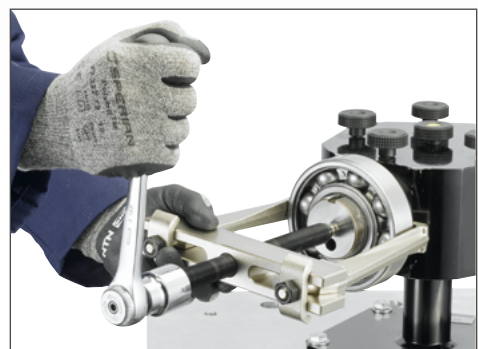
Extraktion durch Außengreifen
