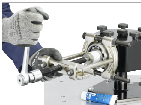
Демонтаж при помощи экстрактора
