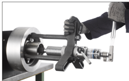
Приложение осевого усилия при монтаже
