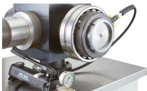
Estrazione della bussola di serraggio con ghiera idraulica
