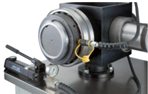
Montagem na luva de remoção por impulsão indiretamente da porca hidráulica
