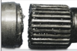
Rupture éléments de liaison
