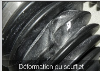
Plopage = inversion de la forme du soufflet ou déformation du soufflet
