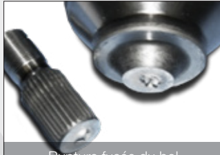
Rupture fusée du bol
