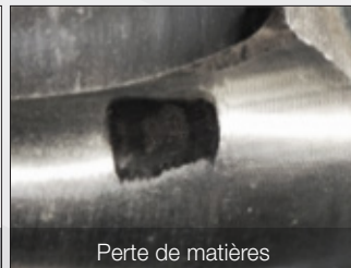
Rupture fusée du bol
