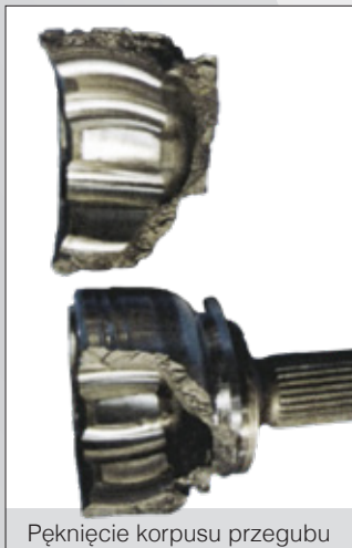
Pęknięcie korpusu przegubu
