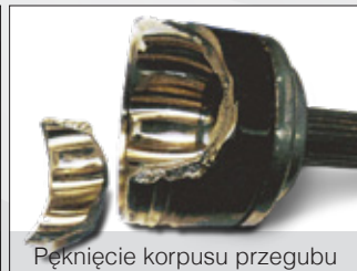
Pęknięcie korpusu przegubu
