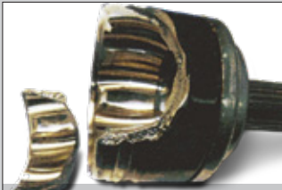
Pęknięcie korpusu przegubu
