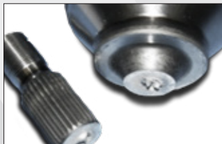
Pęknięcie korpusu przegubu
