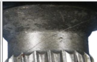
Pęknięcie korpusu przegubu
