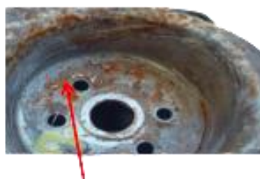
Образование коррозии из-за смещения пружины
