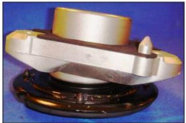
Остаточний вигляд опори після збирання
