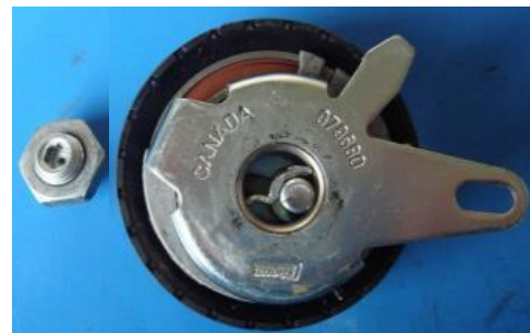
Rolka GT357.28 z pękniętym trzonem
