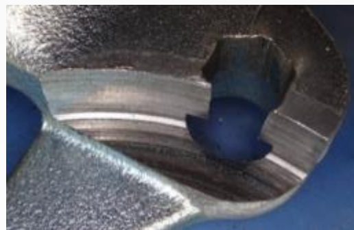
Ślad tarcia na skutek kontaktu z rolką
