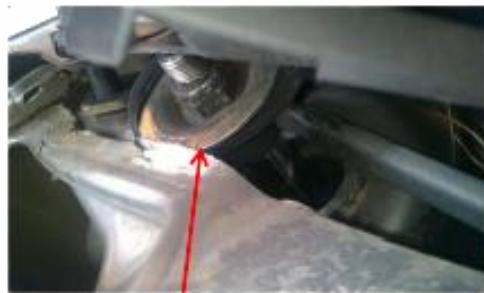
Reggispinta e blocco filtrante di cattiva qualità Asta dell'ammortizzatore che ha perforato la carrozzeria
