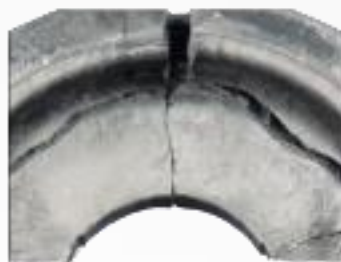
Reggispinta difettoso : rottura della molla d'appoggio del reggispinta
