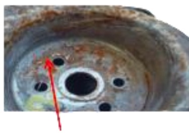
Intaccamento dovuto a spostamenti della molla nel reggispinta
