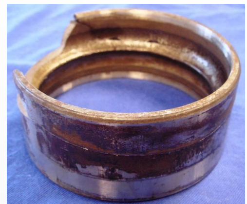
Последствия изношенного посадочного места
