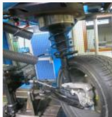
Stanowisko pomiarowe zawieszenia w Centrum Testowym NTN Europe
