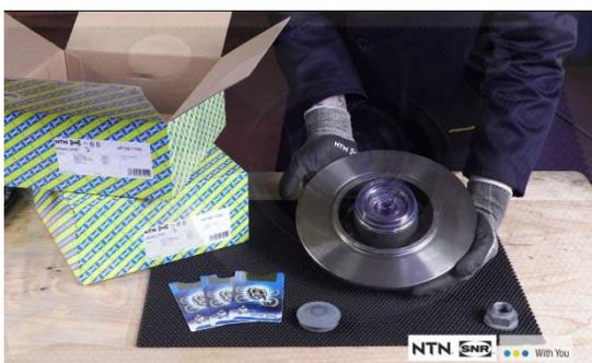
4. Antes de proceder al montaje del nuevo KF, para aquellos dotados de la tecnología ABS® se debe quitar la protección justo antes del montaje, evitando cualquier golpe sobre el codificador magnético, así como el posible contacto con una superficie sucia y/o magnética. Verificar al uniformidad de los polos magnéticos de la junta codificada, por medio de la tarjeta de control ABS®.
