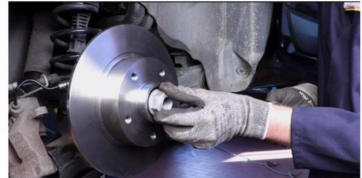
Para facilitar el montaje de los kits y rodamientos de rueda, NTN-SNR indica en las etiquetas de sus productos el par de apriete a respetar.
