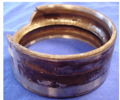
Rolamento desgastado e instalação enviesada
