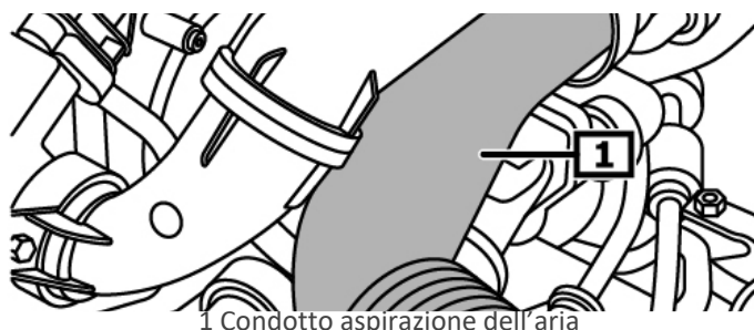
1 Condotto aspirazione dell'aria
