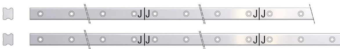
Bild 3.6 Kennzeichnung von geteilten Schienen
