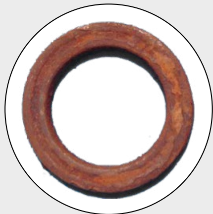
Durch eingedrungene Verunreinigungen korrodiertes Federbeinstützlager
