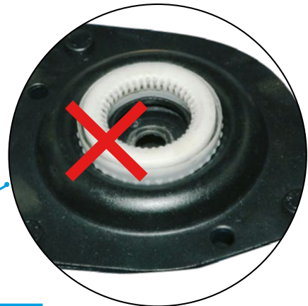
Falsche Montage Drehen der Lenkung beeinträchtigt
