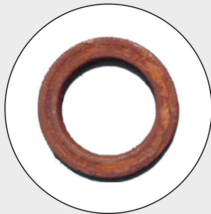
Butée de suspension corrodée suite à l'entrée de pollutions
