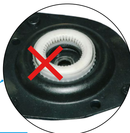
Verkeerde montage het besturen van de wielen wordt belemmerd
