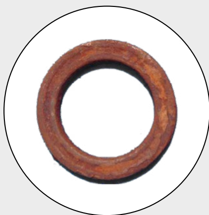
Gecorrodeerd veerpootlager na het binnendringen van vervuiling
