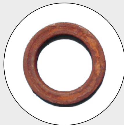
Łożysko zawieszenia skorodowane na skutek wnikania zanieczyszczeń
