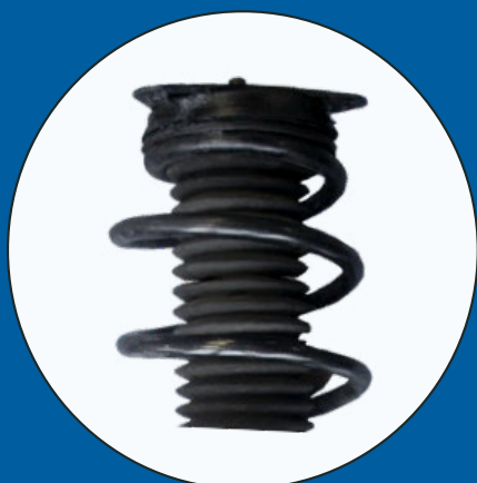
Zniszczona poduszka zawieszenia
