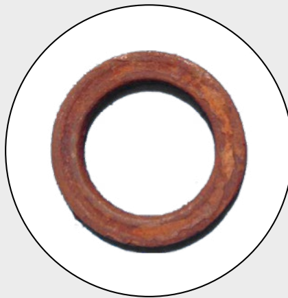
Коррозия опорного подшипника вследствие воздействия загрязнителей
