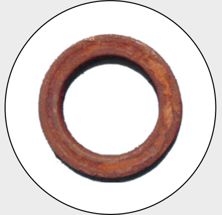
Kir girişi nedeniyle korozyona uğramış amortisör rulmanı
