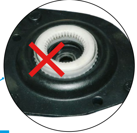
Yanlış montaj Direksiyon sisteminin dönüşü bozulur
