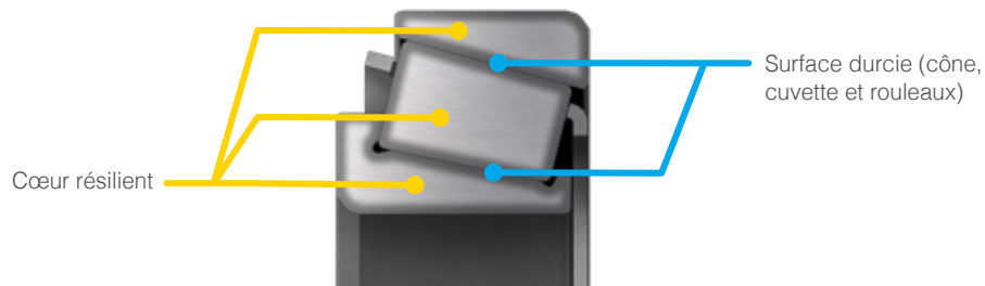
Section transversale d'un roulement en acier cémenté
