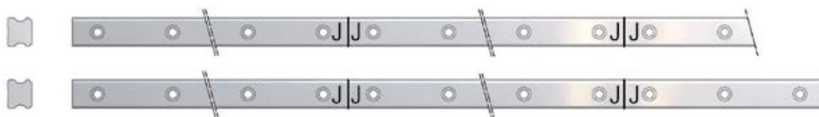
Figure 3.6 Identification des rails aboutés
