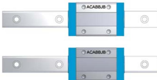
Figure 3.4 Identification de guidages linéaires montés en parallèle
