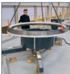
Ce dispositif spécial, développé pour une application éolienne, est capable de chauffer à 120°C en 60 minutes, des pièces pesant jusqu'à 10 tonnes d'un diamètre extérieur de 4 mètres.
