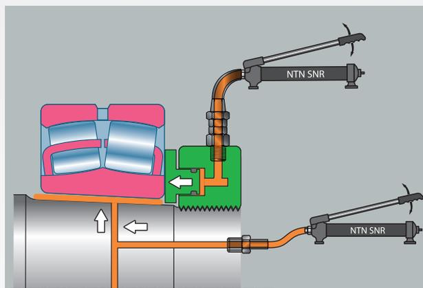
Écrous hydraulique + injection d'un film d'huile
