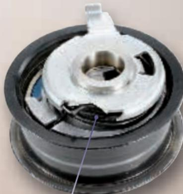
Metallindex ist gegen den unteren Anschlag geschlagen oder gebrochen
