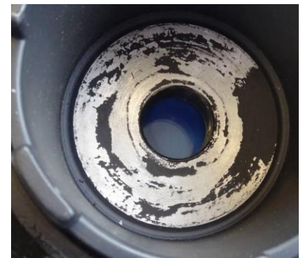
Cara de apoyo de la arandela de fijación frotando a causa del juego
