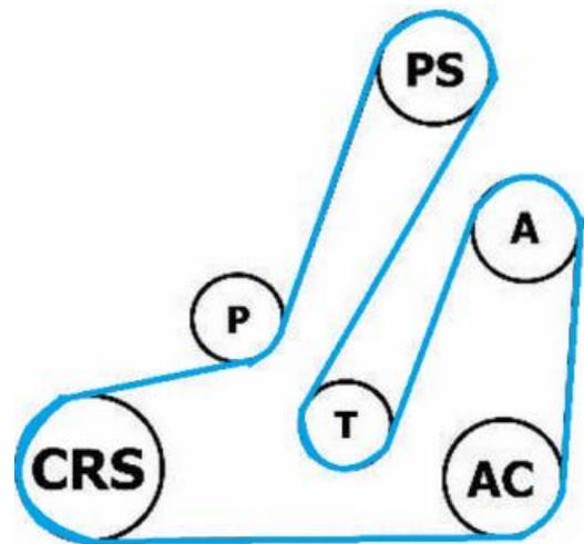
Otra pieza puede estar desalineada o defectuosa sobre el recorrido de la correa:
