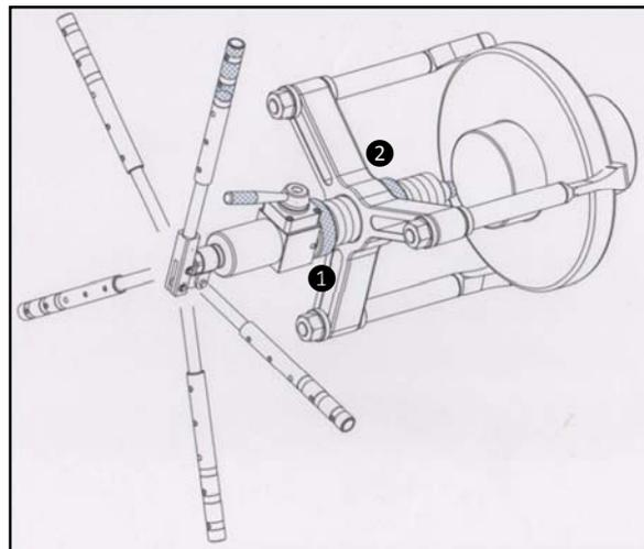
3. Wenn Sie den Abzieher ausgerichtet haben, können sie den Hebel des Steuerventils auf „Bewegen“ („Advance“) setzen und den Hebel betätigen, um die Zugstange ausziehen, damit sie das Achsenzentrum berührt. Positionieren Sie nun die Zugarme fest um das Demontageteil. Betätigen Sie weiterhin den Hebel bis das Demontageteil entfernt wurde.
