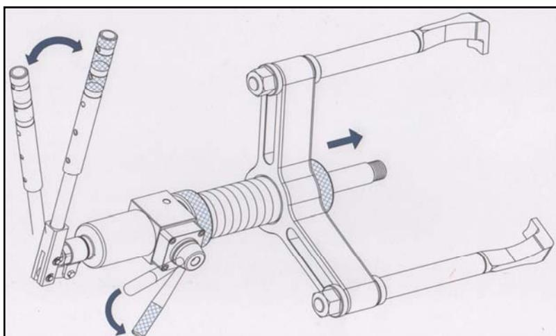
3. Befestigen Sie die Zugstange fest mit dem Verbindungsstück und platzieren Sie die 3 Zugarme gleichmäßig gegen die innere Kante des Teils. Stellen Sie sicher, dass der Stellring ① den Kreuzkopf berührt, und dass der Stellring ② sich in einer Entfernung von dem Kreuzkopf befindet.
