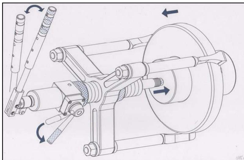
4. Nachdem das Teil demontiert wurde, bewegen Sie den Hebel des Steuerventils zu „Einziehen“ („Retract“), um die Zugstange vollständig zu entfernen.
