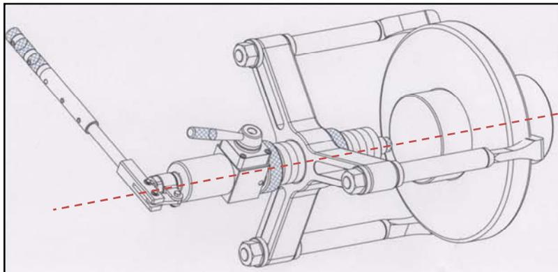
2. Stellen Sie sicher, dass der Stellinging ① sich in einiger Entfernung von dem Kreuzkopf befindet, und dass der Stellinging ② den Kreuzkopf fest berührt. Bringen Sie die Schutzabdeckung an, wenn alles zum Abziehen bereit ist.
