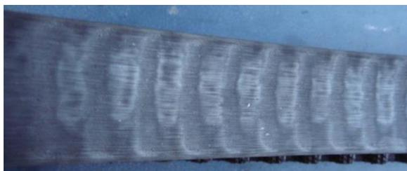
В данном случае ремень проскальзывает на роликах (следовательно, наблюдается износ задней поверхности).
