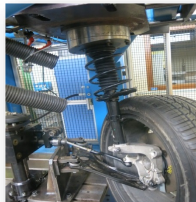
Zkušební stolice pérování v testovacím centru NTN-SNR
