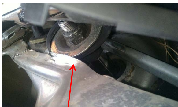
Nekvalitní díl ložisko zavěšení a jednotka oddělení
