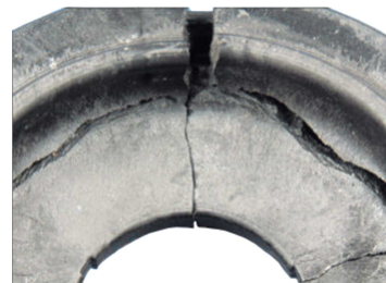
Defect schokdemperlager: Gebroken veerpootschotel
