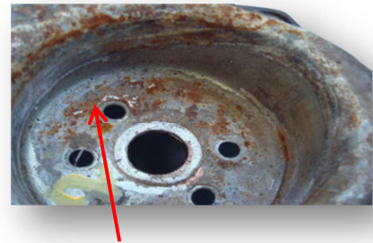
Corrosie die door het bewegen van de veer wordt veroorzaakt
