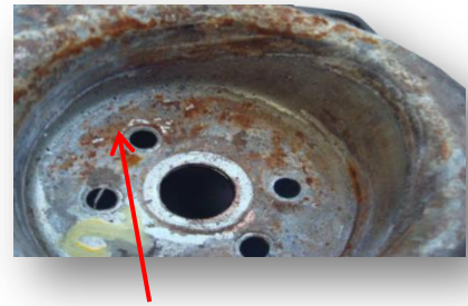
Corrosión provocada por la migración del muelle
