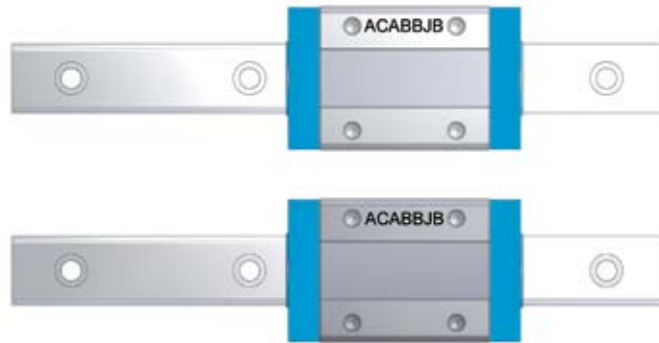
Bild 3.4 Kennzeichnung der Haupt- und Nebenführung
