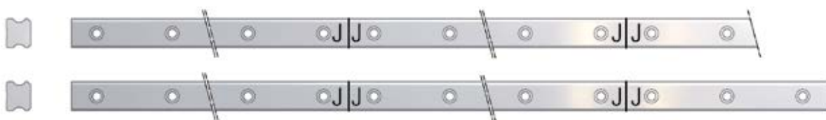
Bild 3.6 Kennzeichnung von geteilten Schienen
