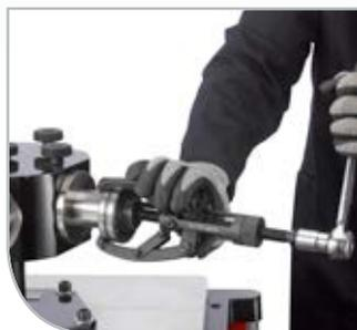
Eine Baureihe einfacher, robuster und leistungsstarker Werkzeuge für den leichten und gefahrlosen Ausbau von Wälzlagern mit kleinen und mittleren Abmessungen.
