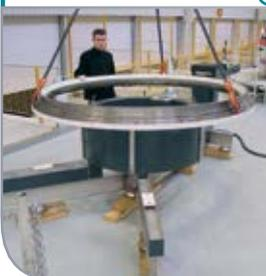
Dieses Spezialgerät, entwickelt für eine Windkraftanlage, kann Bauteile bis 10 Tonnen mit einem Außendurchmesser von 4 Metern innerhalb von 60 Minuten auf 120°C aufheizen.
