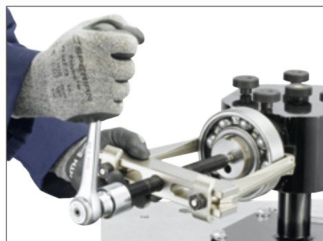
Demontaż za pomocą uchwytu z dwoma ramionami
