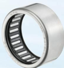
Compacto y ligero, principalmente utilizado en las aplicaciones poco cargadas, el casquillo de agujas es una solución de rodamiento muy económica, ya que el anillo exterior no está mecanizado sino que se obtiene mediante un proceso de embutido de precisión. Cabe señalar que la geometría de la pista de rodadura es consecuencia de la geometría del alojamiento (el escaso grosor del anillo exterior sólo aporta la dureza y la rugosidad necesarias a la pista de rodadura)..
