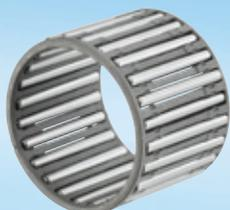
Formada por un conjunto inseparable de jaula y agujas, la jaula de agujas permite diseñar construcciones muy compactas, ligeras, con un máximo de capacidad. Como el eje y el alojamiento sirven de pista de rodadura, deben ser fabricados respetando ciertas características de dureza, geometría y rugosidad. Como las agujas están guiadas con precisión, la jaula de agujas permite aceptar velocidades de rotación mucho más altas que los montajes con agujas sin jaula.
