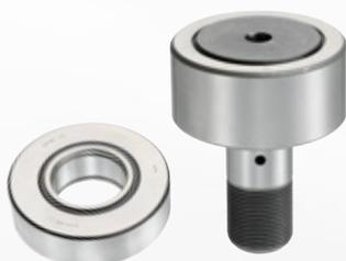
**Los rodillos de levas se utilizan en los casos de aplicaciones que necesiten un guiado con una fricción mínima, como las levas y los sistemas de guiado lineal. Los casos de aplicación del rodillo de leva son muy distintos de los del rodamiento. No se monta en un alojamiento y su anillo exterior más grueso rueda directamente por una superficie para garantizar una función de guiado..**
