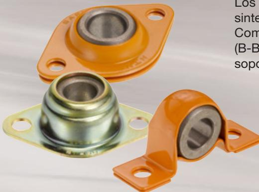
Los soportes B-BAP, B-BAF o B-BSF combinan anillos de bronce sinterizado con mini-soportes de chapa embutida. Como zócalo (B-BAP), en aplique (B-BAF) o en aplique desplazado (B-BSF), estos soportes constituyen una alternativa económica frente a los soportes auto-alineantes clásicos.
