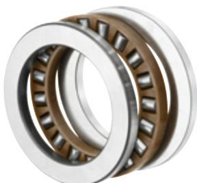
**Los rodamientos axiales de agujas o de rodillos están diseñados para soportar exclusivamente esfuerzos axiales en un único sentido. Las superficies de apoyo que sirven de pista de rodadura deben ser rectificadas y templadas.**
