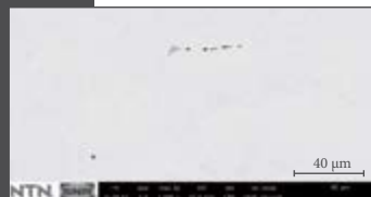
Aluminat-Einschlüsse in vergleichbarer Größenordnung unter dem Rasterelektronenmikroskop.
