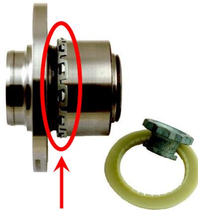
Presencia de un anillo metálico
