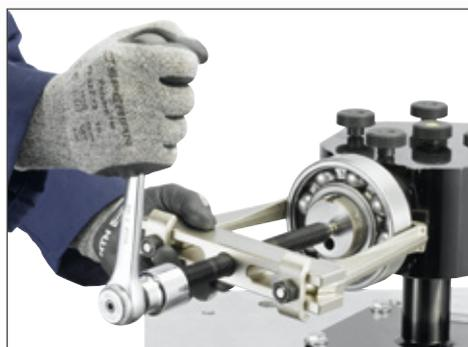
Extracción con sujeción exterior
