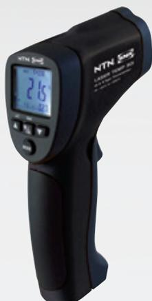
Establezca un diagnóstico preliminar del funcionamiento de su máquina mediante la medición precisa y segura de la temperatura, a distancia o por contacto.
