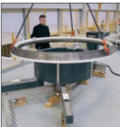
Este aparato, especialmente desarrollado para una aplicación eólica, es capaz de calentar a 120°C en 60 minutos piezas que pesan hasta 10 T, y que tienen un diámetro exterior de 4 m.
