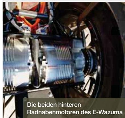
Die beiden hinteren Radnabenmotoren des E-Wazuma
