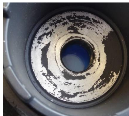
Vestígios de lascagem na face de contacto frontal da polia são uma indicação de um parafuso de fixação mal apertado.
