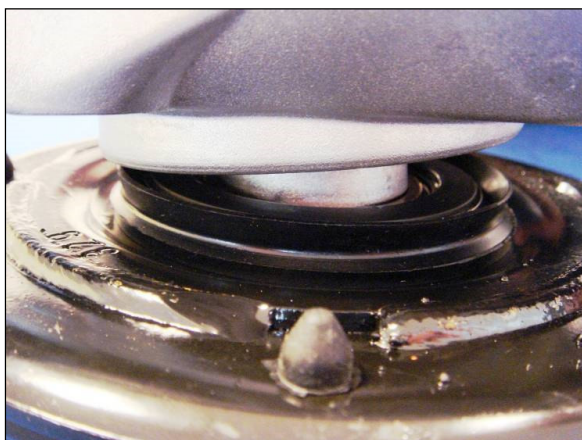
Inserimento del blocco filtrante nella coppa
