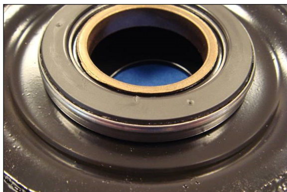
Installazione corretta del reggispinga
