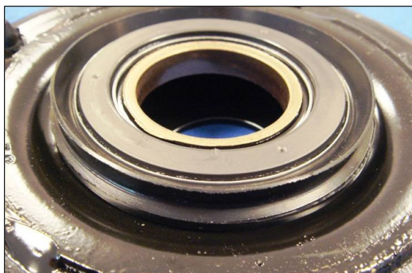
Installazione della guarnizione sul reggispinga
