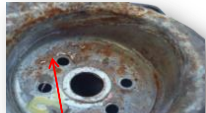
Corrosão provocada pelo movimento da mola
