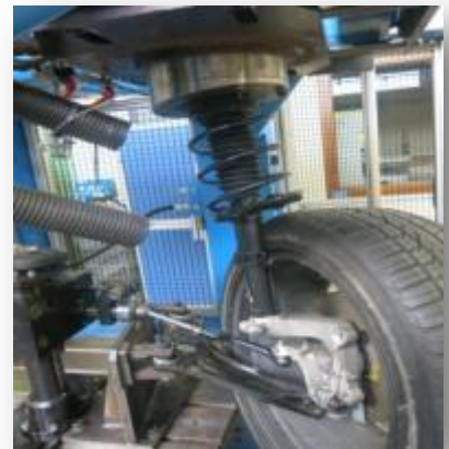
Bancada de testes de suspensão no Centro de Testes da NTN-SNR
